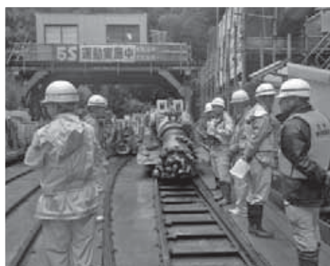
排水トンネル自由断面掘削機
