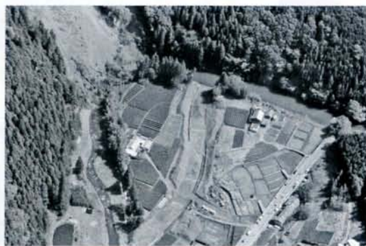
▲完了した仮排水路(中央)を上空から臨む(右側は国道362号)。堰きとめられた水があふれ出せば周辺の民家や農地に大きな被害が及ぶ事態が想定された。
